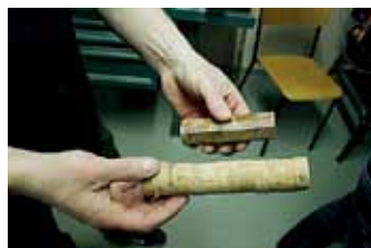
Handtaget tillverkas av kork som limmas och putsas. Rullfästet är av lönn.
